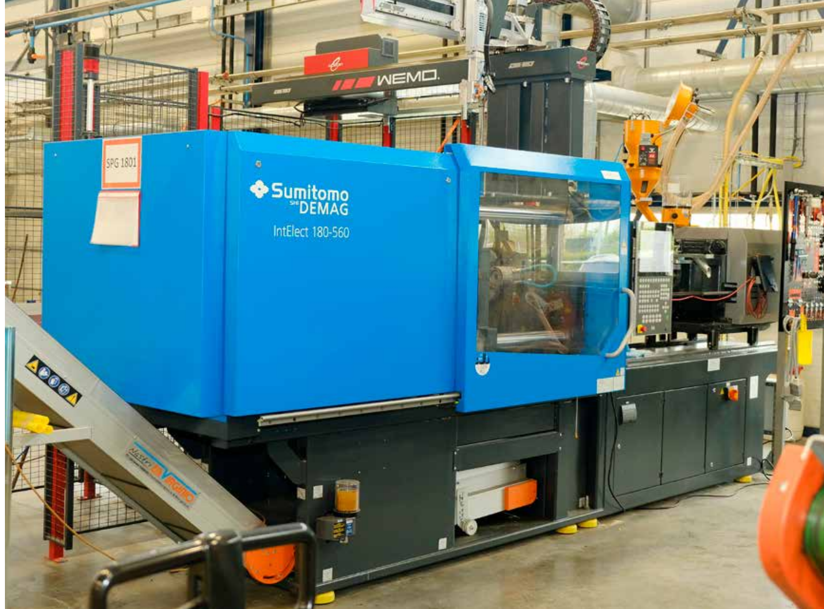
180 tons vol-elektrische Sumitomo-Demag, één van de nieuwe spuitgietmachines bij Isiflo.
