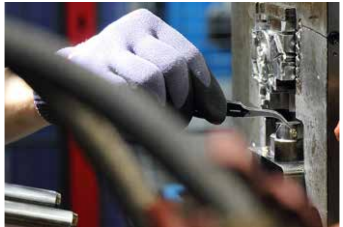
Kleine series en handmatig werk zijn bij Egmond Plastic geen uitzondering. Hier een onderdeel met omspoten inserts die met de hand in de matrijsholte worden geplaatst.
