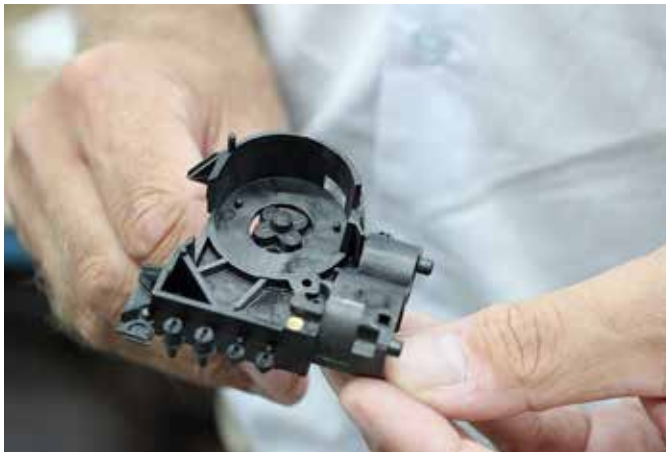
Kleine series en handmatig werk zijn bij Egmond Plastic geen uitzondering. Hier een onderdeel met omspoten inserts die met de hand in de matrijsholte worden geplaatst.
