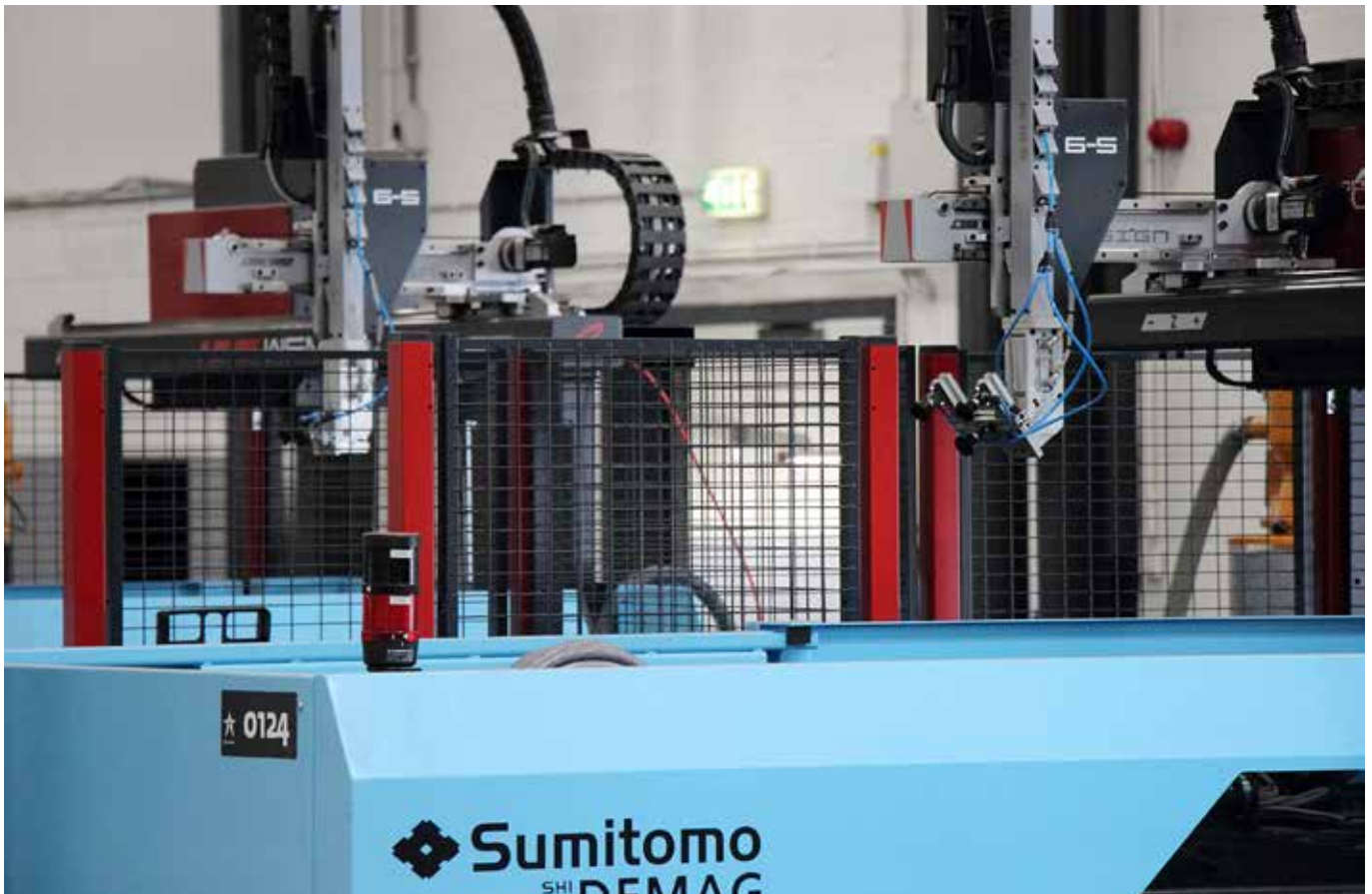
Als onderdeel van de automatiserings- en professionaliseringslag bij AKROH zijn de nieuwe spuitgietmachines ook allemaal uitgerust met Wemo-handlingrobots, eveneens geleverd door Thiele & Kor.
