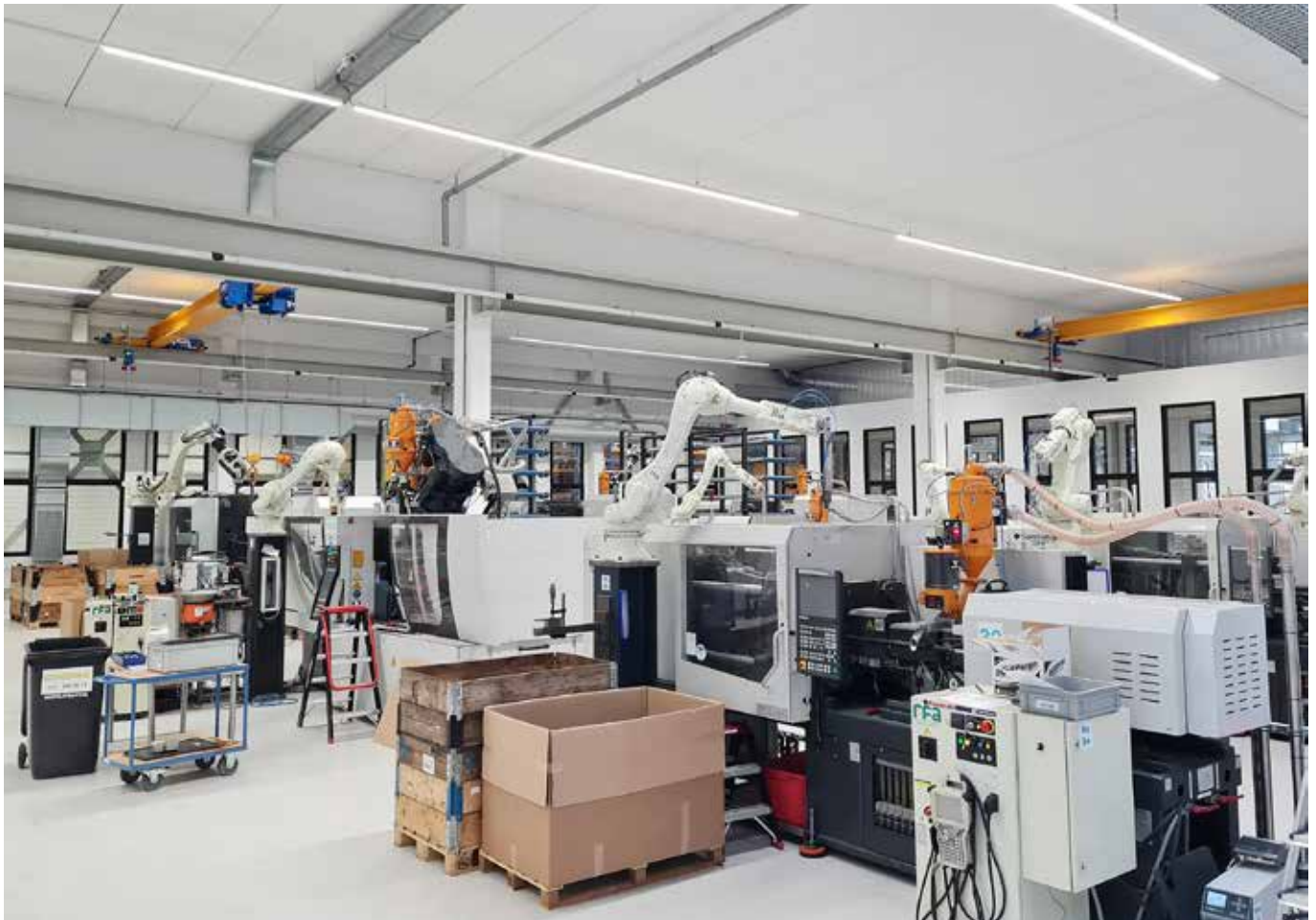
In de gloednieuwe fabriek van Tacx staan onder andere 23 gerobotiseerde elektrische spuitgietmachines van Sumitomo Demag.
