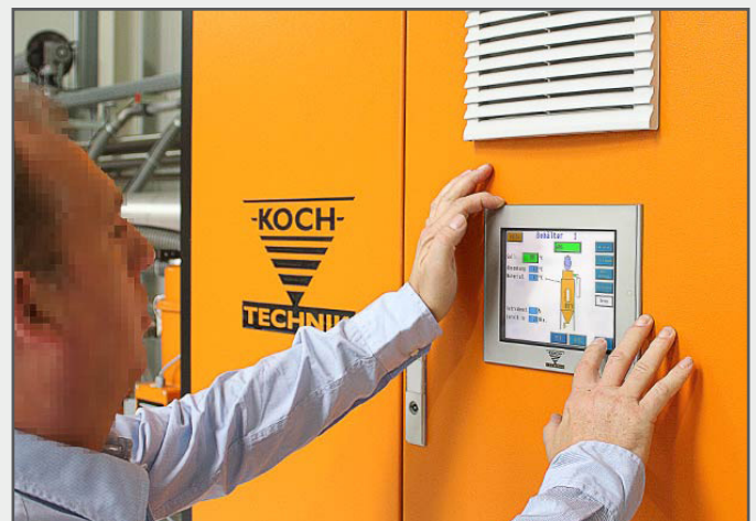
Alle EKO-N aggregaten zijn uitgevoerd met een 10,4" touchscreen met een siemens S7 PLC-besturing
