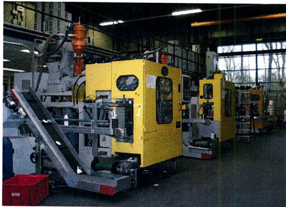
Tacx heeft drie blaasvormmachines voor de productie van bidons.
