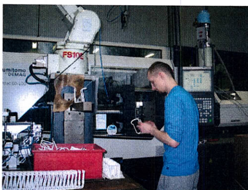
Het insert-spuitgieten van kunststof onderdelen aan bidonhouders.
