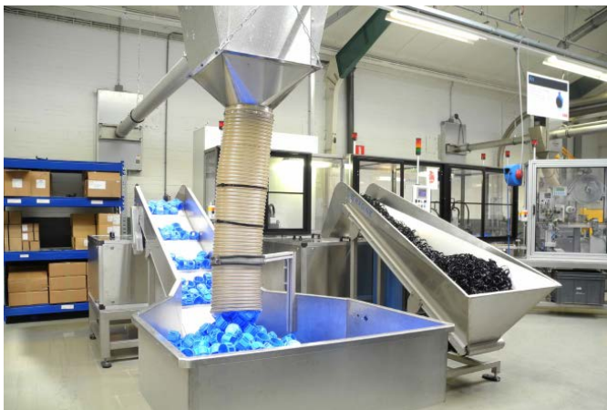
De multidozen gaan via een airmove systeem van de spuitgietsmachine naar de assemblageafdeling.
